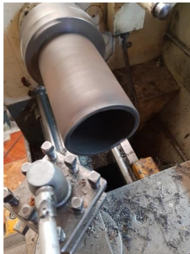
Figura 44. Mecanizado de la primera parte de la cámara de combustión
